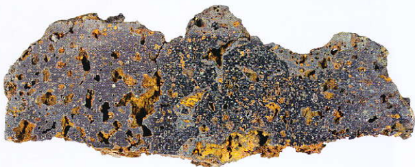
Aufgetrennte und angeschliffene Luppe: Das Metall zeigt eine amorphe Struktur, Breite 13 cm.
