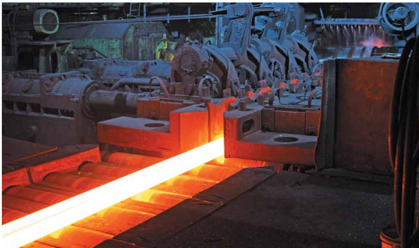
Vierkant-Knüppel auf dem Rollengang vor dem Duo-Blockwalzwerk in Freital (Foto Joachim Schlegel)
